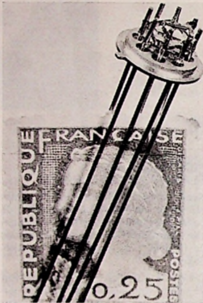
Micromodules van Sesco in een TO 5-behuizing.
